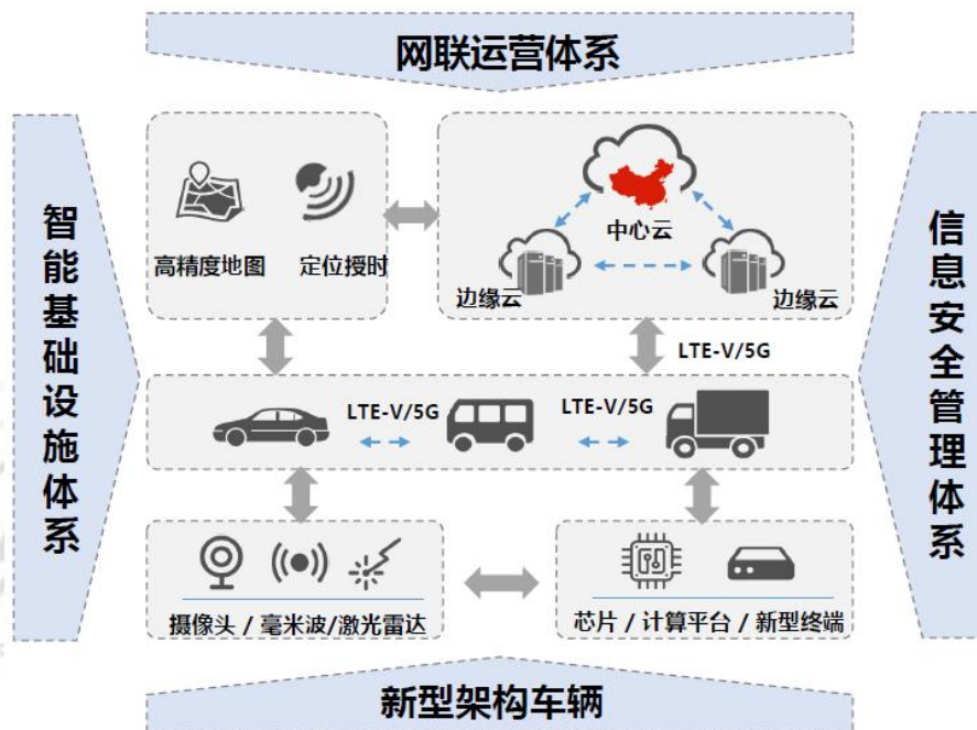
图4 中国方案智能网联汽车体系架构
